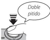
**Si la cámara puede enfocar**, sonará un pitido dos veces y la lámpara indicadora se iluminará en verde.
