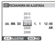
2.1 Pulse el selector hacia la izquierda o hacia la derecha para resaltar el año, mes, día, horas o minutos y púlselo hacia arriba o hacia abajo para cambiar los valores mostrados. Para cambiar el orden en que se visualiza el año, mes y día, resalte el formato de fecha y pulse el selector hacia arriba o hacia abajo.
