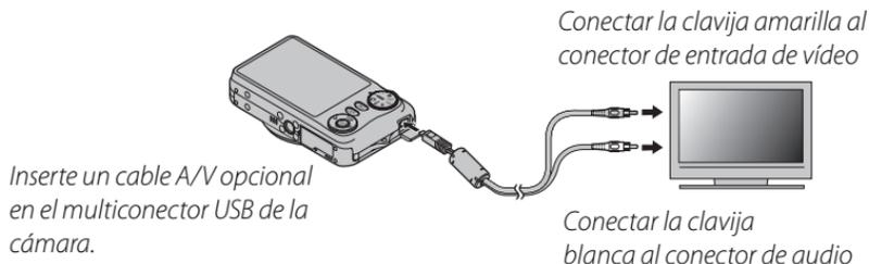
Pulse **▶** durante aproximadamente un segundo para encender la cámara. La pantalla de la cámara se apaga y los comentarios de voz se reproducen en el televisor. Tenga en cuenta que los controles de volumen de la cámara no tienen ningún efecto sobre los sonidos reproducidos en el televisor; utilice los controles de volumen del televisor para ajustar el volumen.
