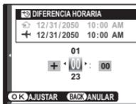
1.3 Pulse el selector hacia la izquierda o hacia la derecha para resaltar **+**, **-**, horas o minutos; púlselo hacia arriba o hacia abajo para modificar la hora. El incremento mínimo es de 15 minutos.
