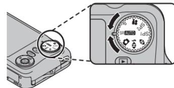
**P (AE PROGRAMADO):** Seleccione esta opción para controlar los ajustes de la cámara, como la compensación de la exposición, el balance de blancos y la sensibilidad ISO. El modo ajusta automáticamente tanto la velocidad de obturación como el diafragma del objetivo (pág. 20).
