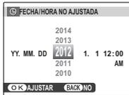
Pulse el selector hacia la izquierda o hacia la derecha para resaltar el año, mes, día, horas o minutos y púselo hacia arriba o hacia abajo para cambiar los valores mostrados. Para cambiar el orden en el que se visualiza el año, mes y día, resalte el formato de fecha y pulse el selector hacia arriba o hacia abajo. Pulse **MENU/OK** para salir al modo de disparo cuando finalice los ajustes.
