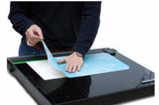
2 Retire el papel protector de la cubierta y alise la hoja de portada sobre la cubierta, de izquierda a derecha.
