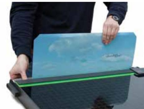
3 Doble los bordes exteriores de la cubierta para fijarlos en la parte interior. Empuje la cubierta dentro del rodillo de presión para que los bordes se adhieran correctamente.
