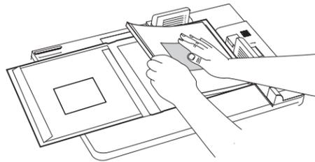
**ENSAMBLE.** El libro terminado se pega a los paneles adhesivos del Fastback Hardcover™ para alinear exactamente el contenido y la cubierta de pasta dura.
